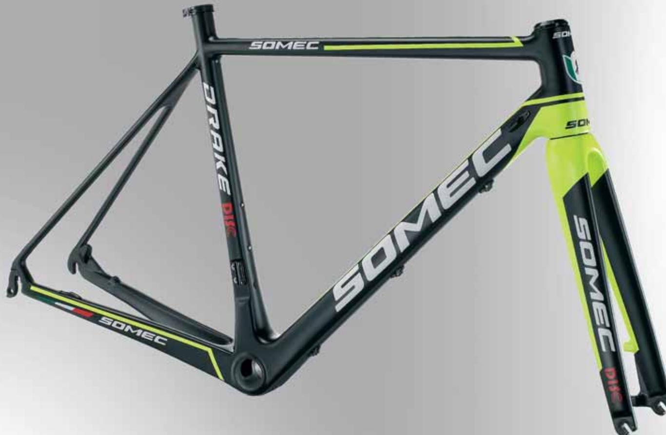
Telaio predisposto per il montaggio del freno a disco, in carbonio monoscocca, Somec design, costruito con sistema EPS. Passaggio cavi interno. Il tubo sterzo a diametro differenziato (sopra 1" 1/8 sotto 1" 1/2) accresce la stabilità in curva e discesa.
