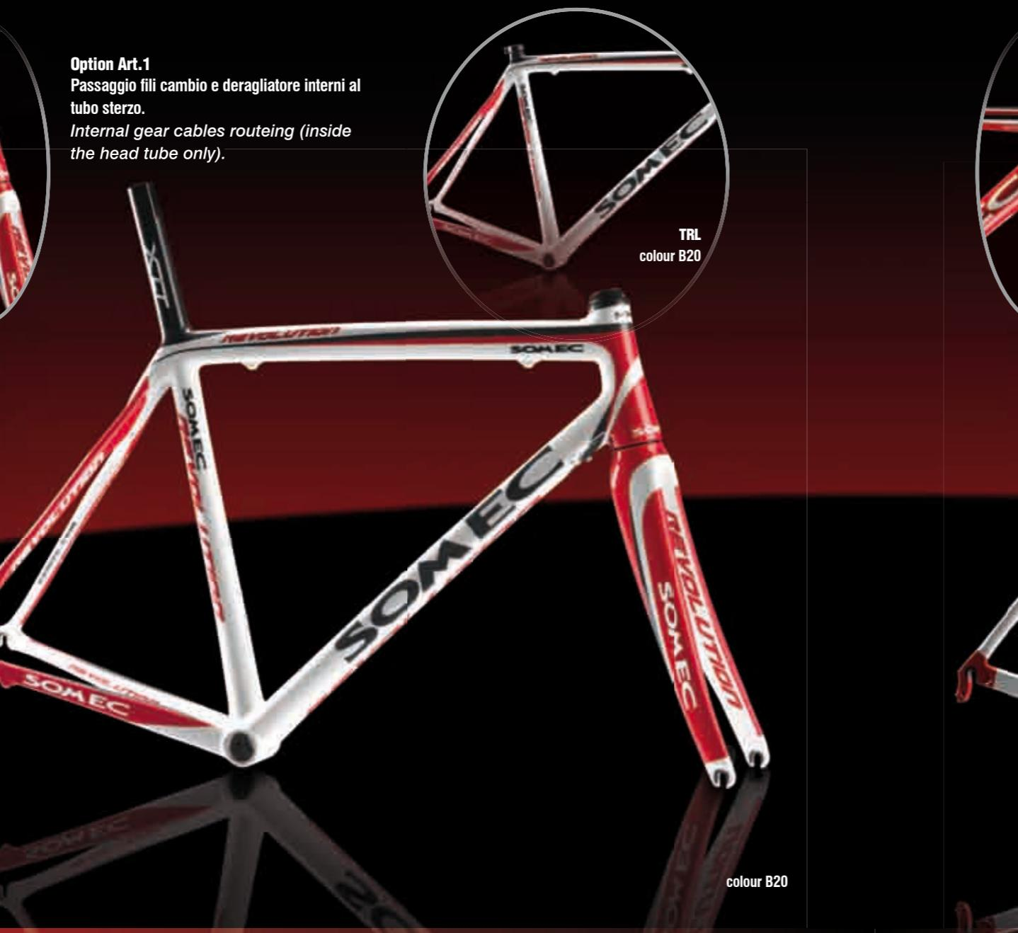
Il tubo sterzo a diametro differenziato (sopra 1" 1/8 sotto 1" 1/2) accresce la stabilità in curva e discesa.
